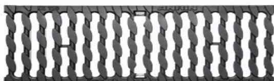
רשת ברזל יציקה אובלי מתאים לעומס: C250, E600 | D400 מתאים לדגמים: KE150,200, 10 מ"מ sw
